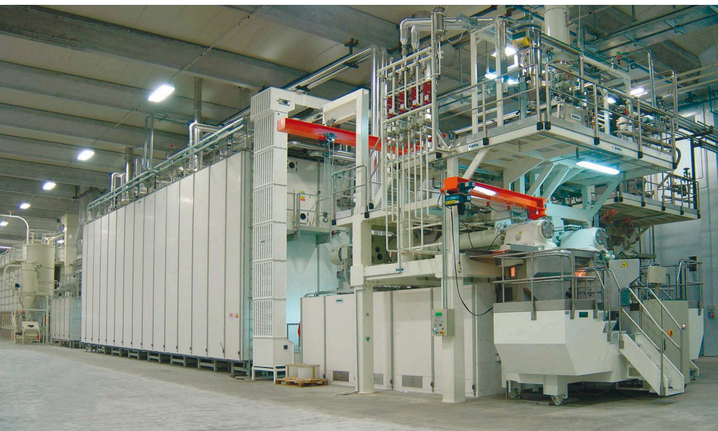
Linea completa per pastifici e particolare del nastro di stabilizzazione dell'impasto (Fava).
